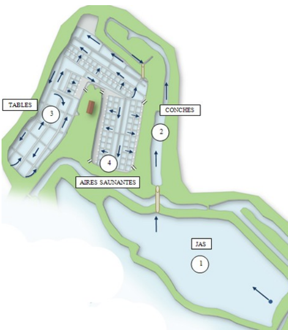
Figura 2 – Plano das salinas. [1 – Viveiro, 2 – Viveiro Secundário, 3 – Áreas de Concentração, 4 – Talhos].
